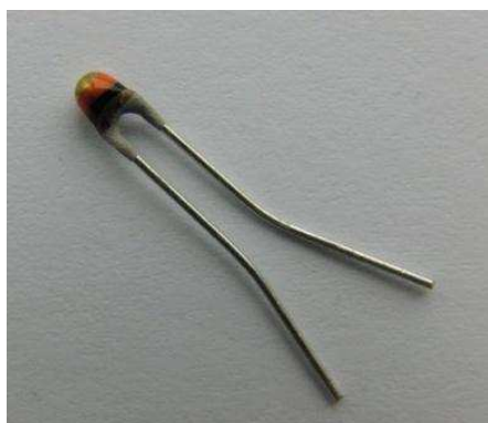
Obr. 1. Perličkový termistor 10\ \text{k}\Omega a změřená závislost jeho odporu na teplotě
