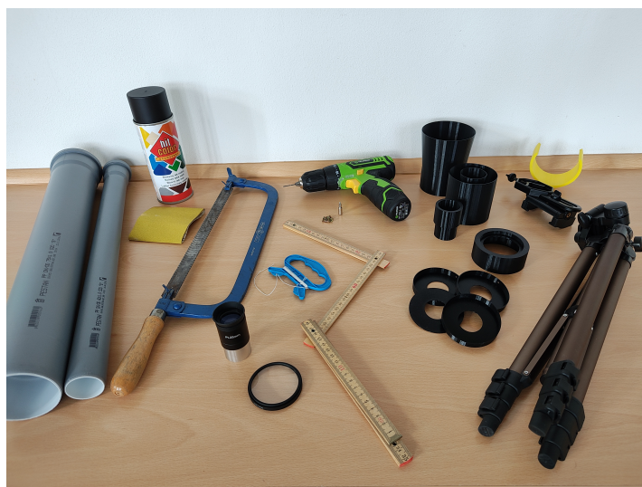
Obrázek 3: Součástky potřebné pro výrobu Keplerova dalekohledu.
