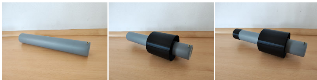
Obrázek 9: Sestavení okularového výtahu. Na jednu stranu přivrtáme jistící vrut, který zabrání vypadnutí okularového výtahu z dalekohledu. Nasadíme držák trubky okuláru a nakonec držák samotného okuláru.
