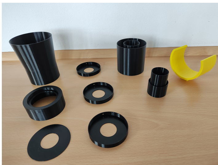
Obrázek 4: 3D vytištěné části k sestavení dalekohledu. Vlevo jsou části objektivu: odshora rosnice, držák objektivu a plochá clona za objektiv. Uprostřed jsou clony určené do hlavního tubusu. Vpravo jsou části příslušející okulárovému tubusu: nahoře jeho držák v hlavním tubusu a dole držák samotného okuláru. Žlutě je vytištěno uchycení dalekohledu, které lze přišroubovat k fotografickému stativu.
