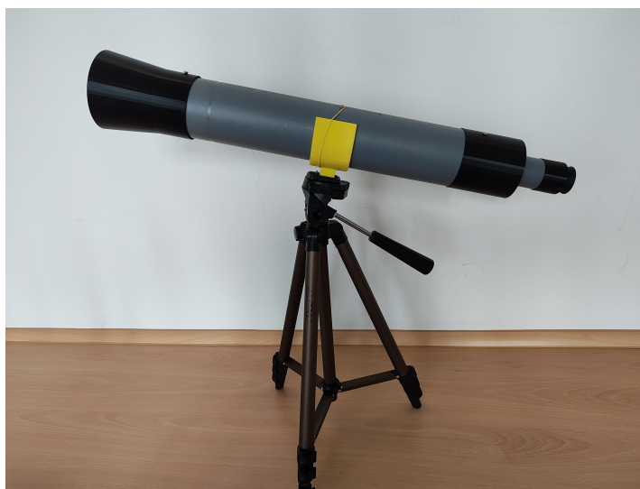
Obrázek 10: Sestavený dalekohled umístěný ve stativu
