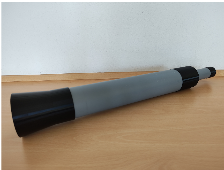
Obrázek 5: Zkušební sestavení hlavního tubusu a okulárové trubky.
