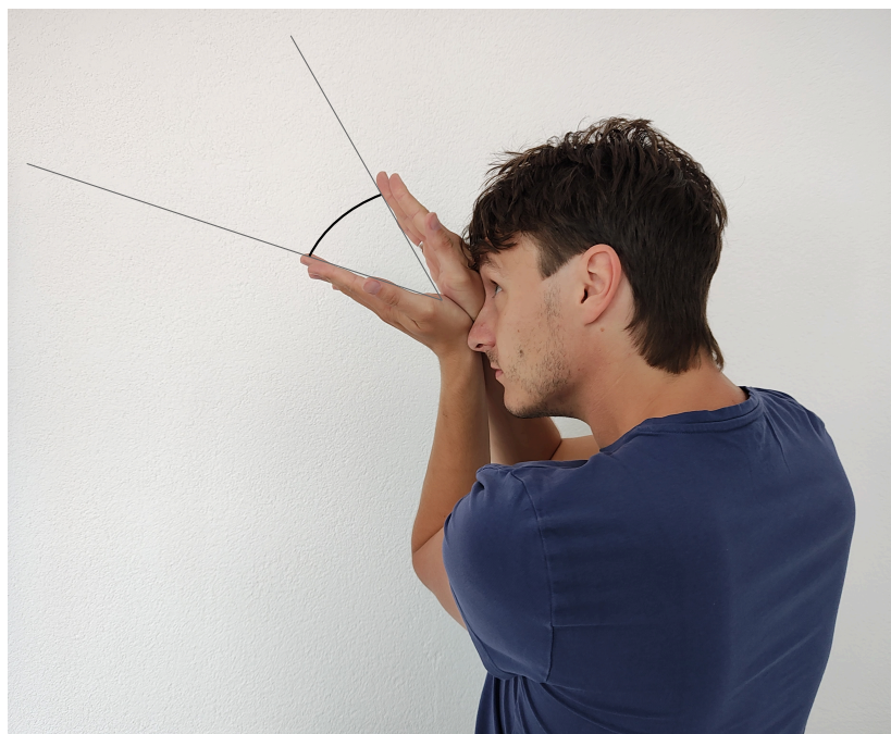
Obrázek 1: Přibližné měření zorného úhlu předmětu.
